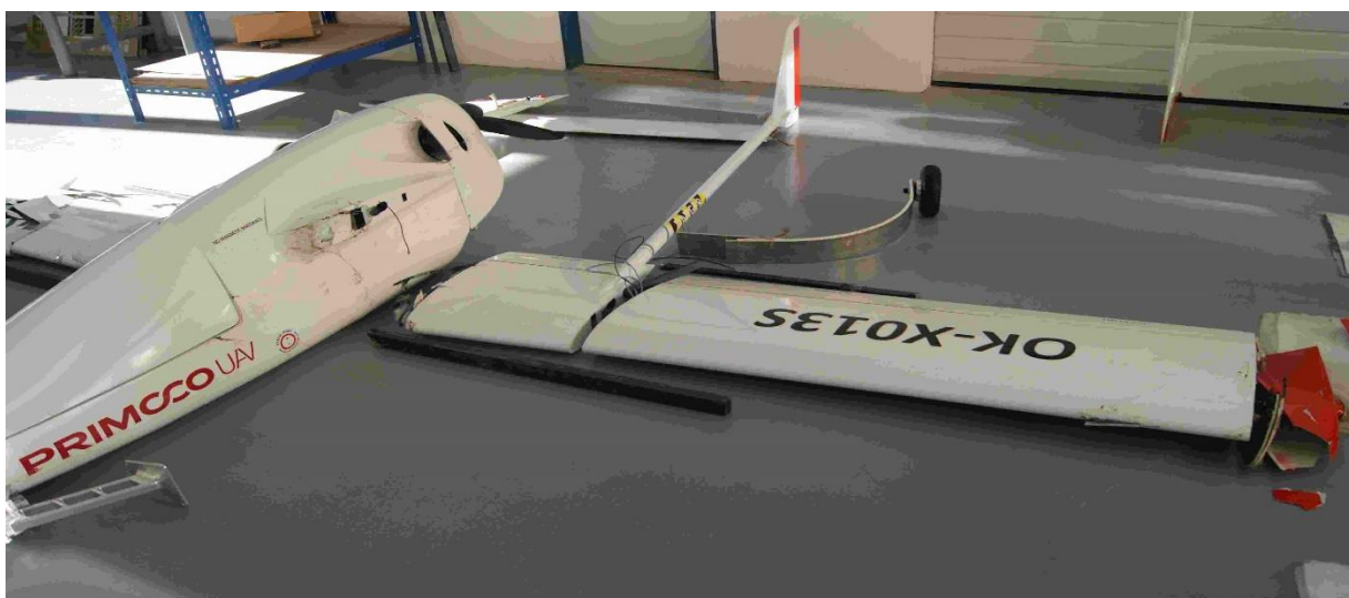
Obr. č. 2: Trosky UA v hangáru provozovatele
