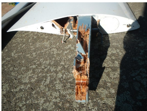
Vylomení spojů nosníku křídla v místě vodorovných čepů
