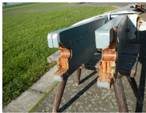
Vylomení spojů nosníku křídla v místě vodorovných čepů
