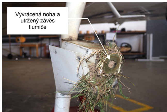
Poškozený konec nohy předového podvozku a závěs tlumiče
