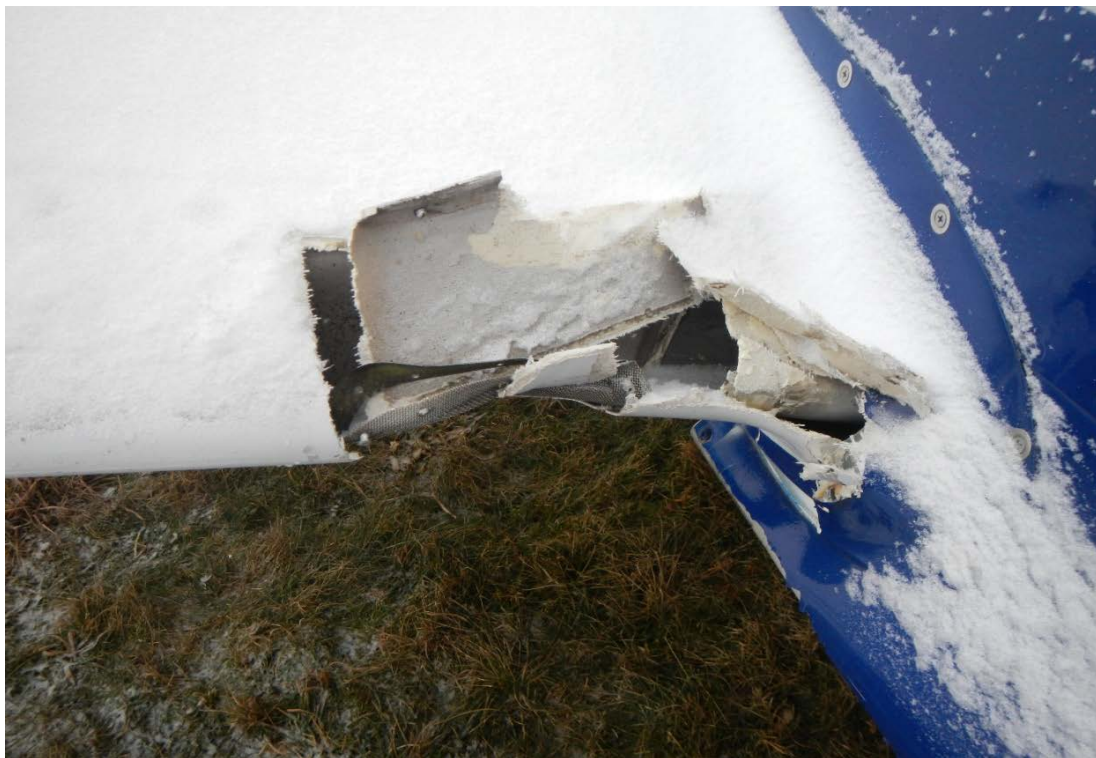
Obr. 3 Prolomení náběžné hrany pravé poloviny křídla způsobené pásy jeřábu při manipulaci s letounem.
