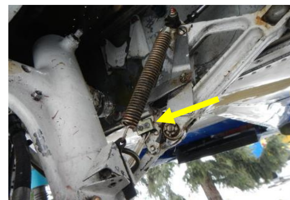
Letounu po přemístění před hangár LET'S FLY s. r. o. Žlutá šipka ukazuje na nezajištěný zámek vysunuté polohy levé hlavní podvozkové nohy, která se při nehodě vylomila.
