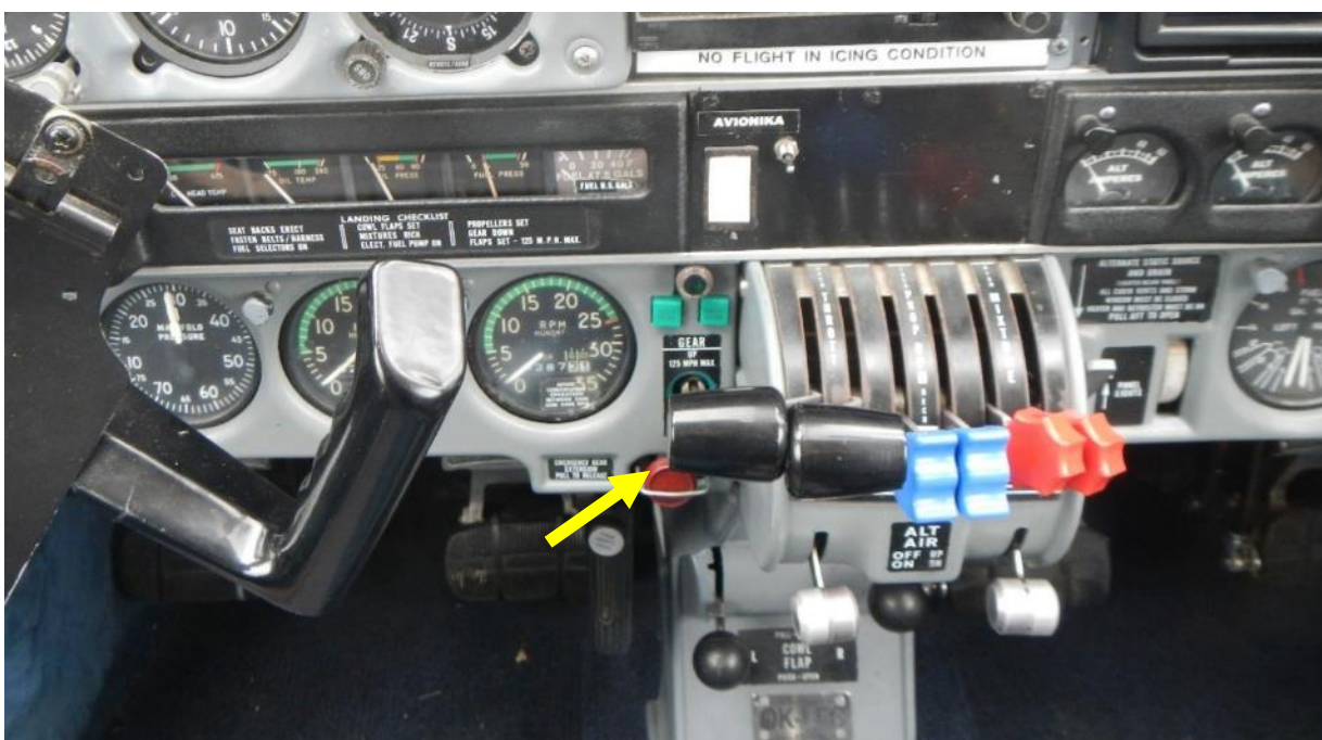
Žlutá šipka ukazuje nepoužitý zajištěný ovladač nouzového vysunutí podvozku. Stav po letecké nehodě. Za pákou ovládání výkonu motoru ovladač podvozku, který je v poloze vysunuto.
