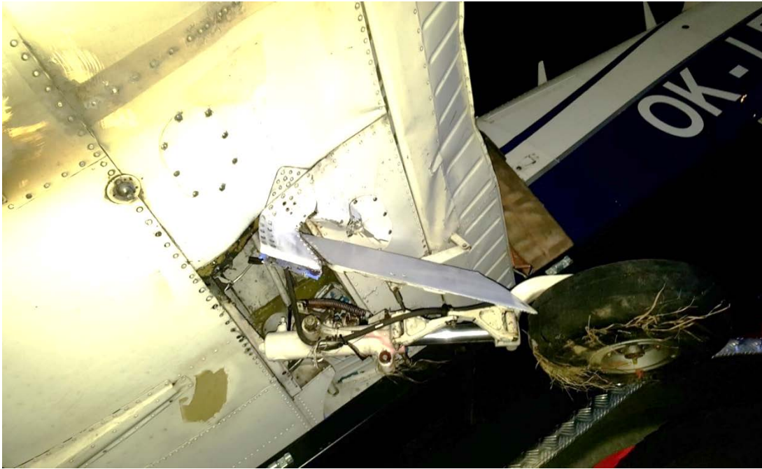
Obr. 2 Vylomená levá hlavní podvozková noha se zdeformovaným krytem podvozku.
