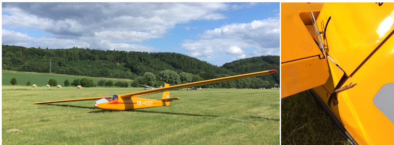
Obrázek č. 1. Pohled na kluzák na místě letecké nehody a detail – poškození konstrukce konce trupu.
