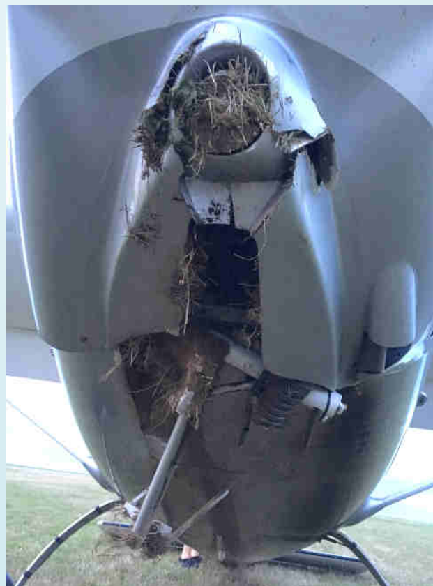
Stav předového podvozku - bez kola
