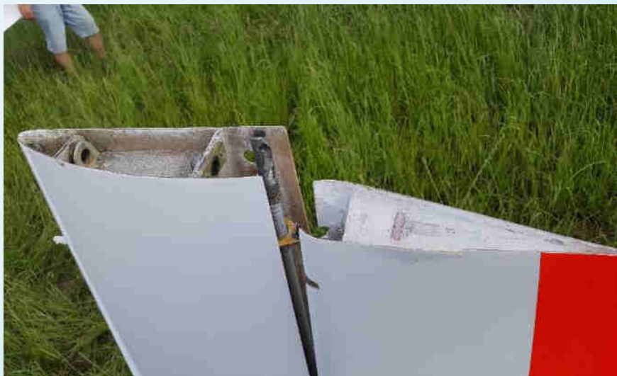
Poškození trupu a SOP kluzáku
