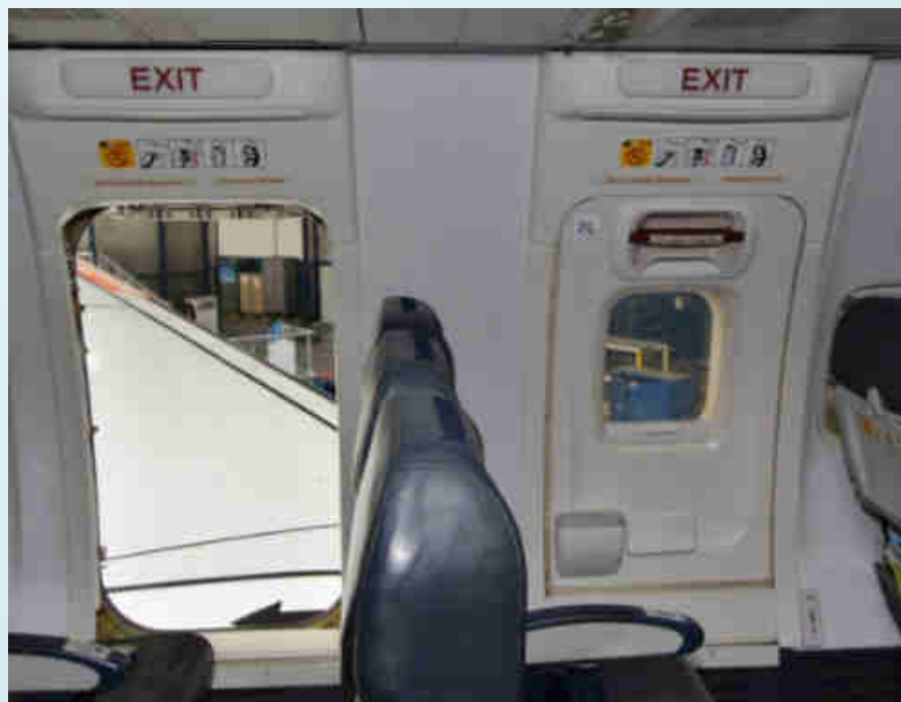
Evakuační východ nad křídlem
