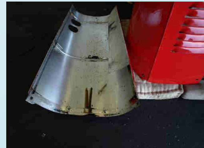
Vnitřní strana spodního dílu kapotáže motoru se zbytky oleje
