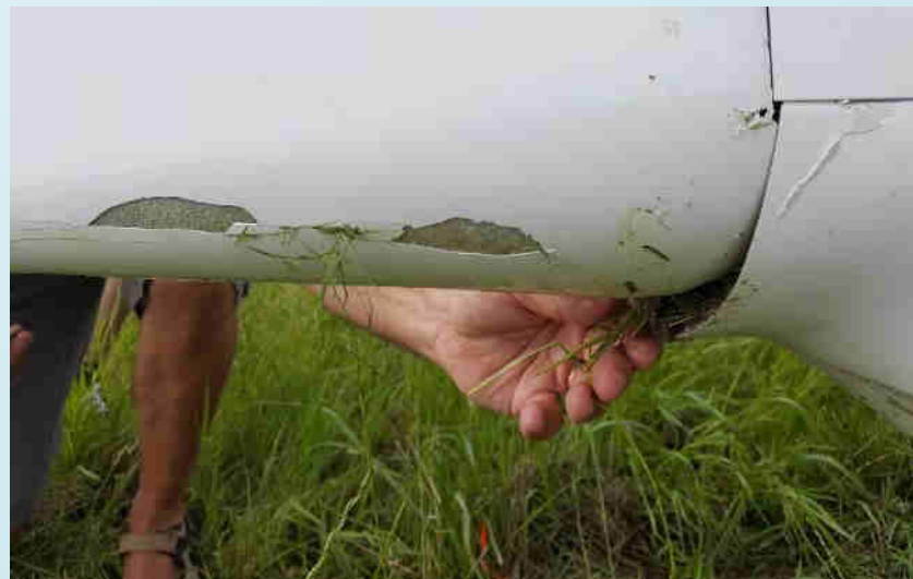
Poškození trupu a SOP kluzáku
