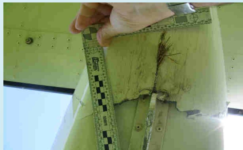
Poškození konce trupu a ostruhy.
