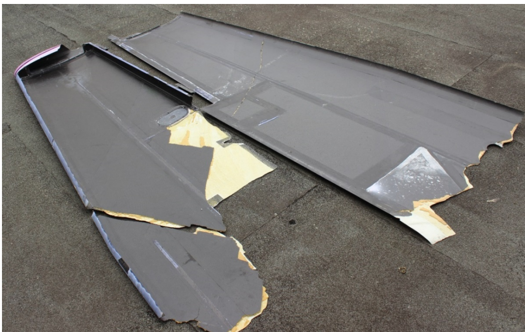
Obr. 3: Části trosek horního a spodního potahu pravé poloviny křídla.
