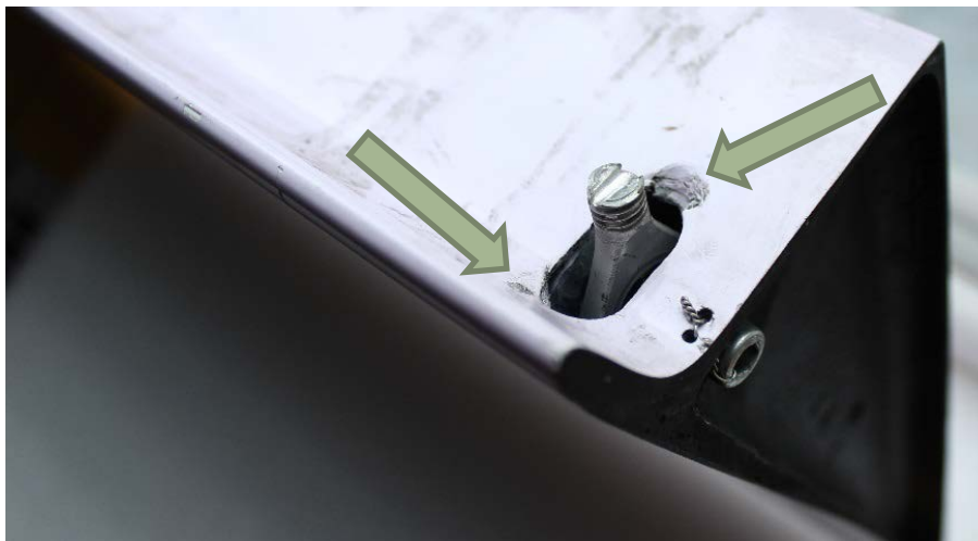
Obr. 5: Detail levého křídélka se stopami otlaků od táhla.
