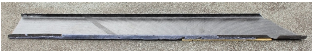
Obr. 4: Trosky předního nosníku pravé poloviny křídla.
