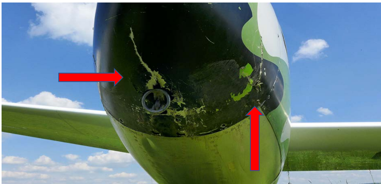
Obr. č. 2: Poškození přídě kluzáku
