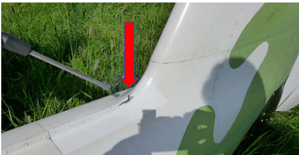
Obr. č. 4 : Roztržený horní hřeben potahu v místě přechodu trup-náběžná hrana kýlu.
