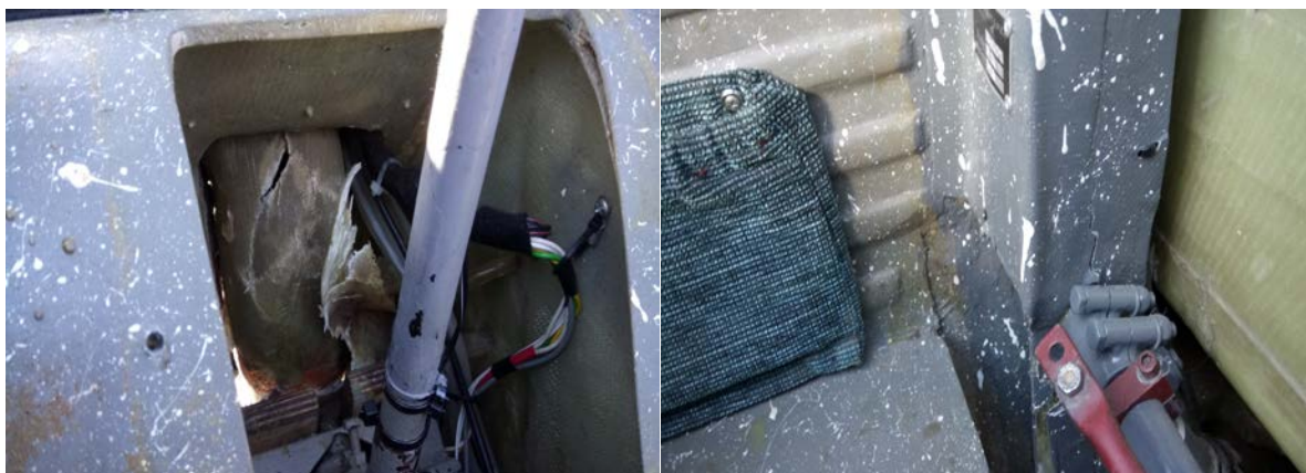
Obr. č. 2: Poškození blatníku předového kola podvozku a hlavní trupové přepážky
