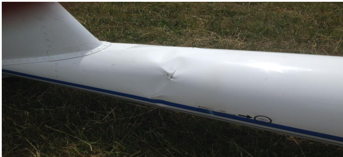
Obr. č. 3: Deformace zadní části trupu (kornoutu)
