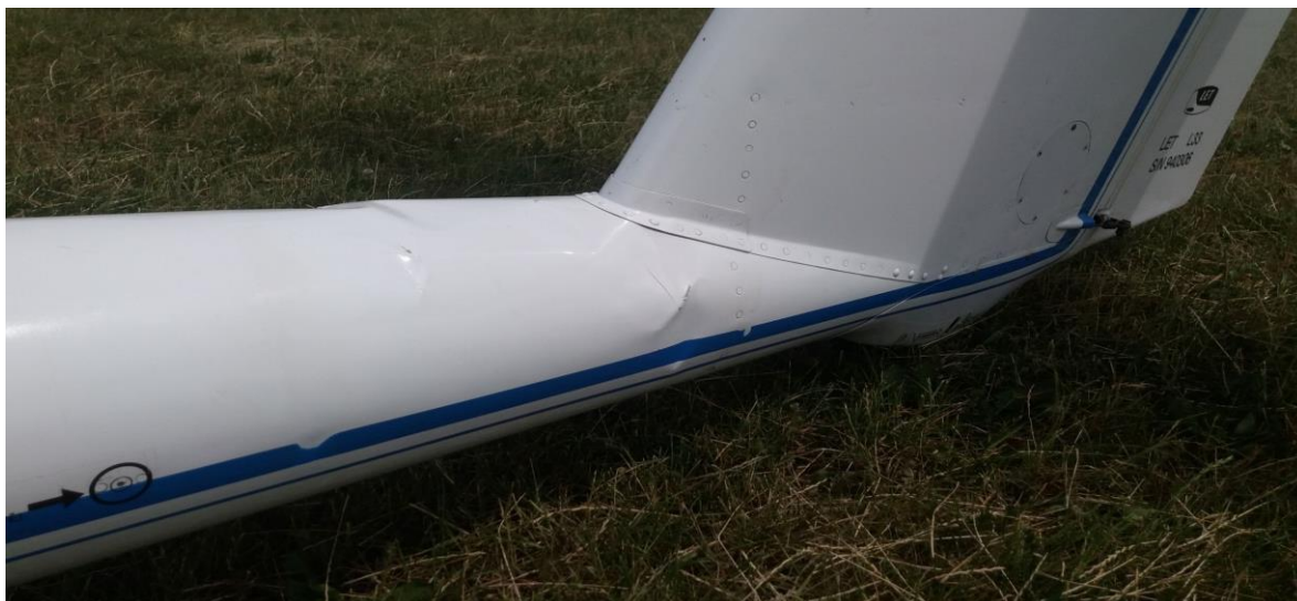
Obr. č. 4: Deformace zadní části trupu (pohled z druhé strany)
