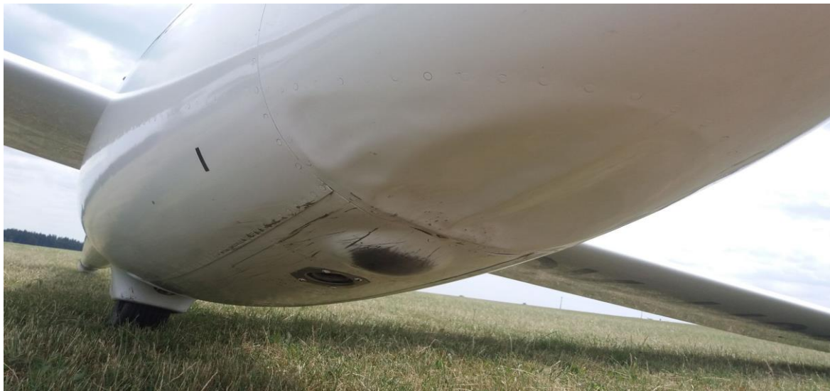
Obr. č. 2: Poškození přídě trupu a botky
