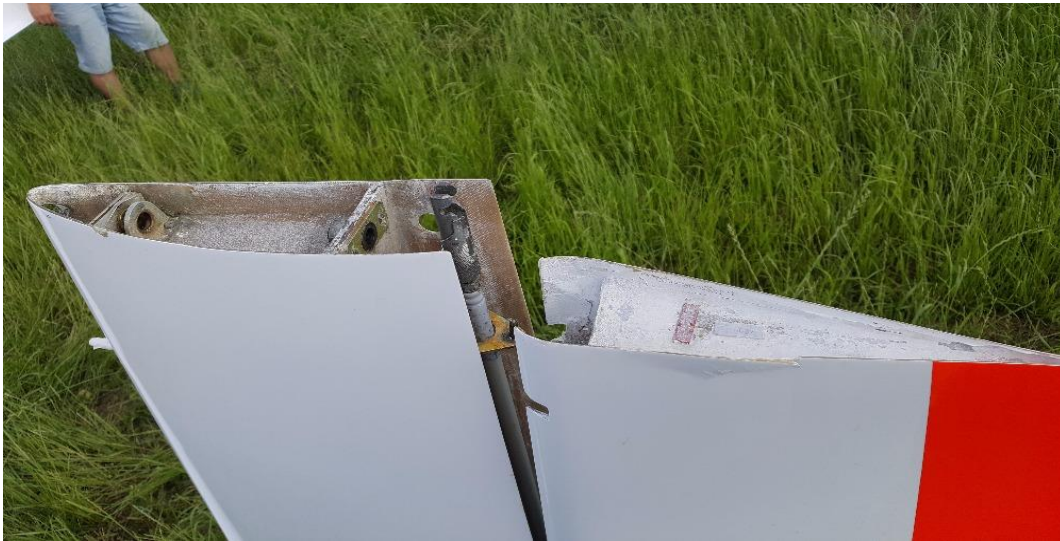
Obr. 6: Poškození ocasních ploch
