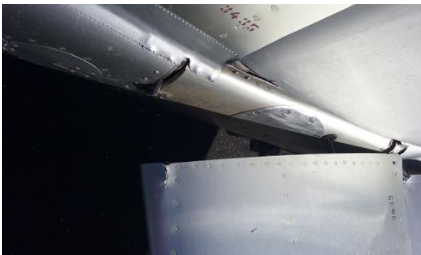
Obr. č. 2: Vytržená levá polovina VOP ze závěsu
