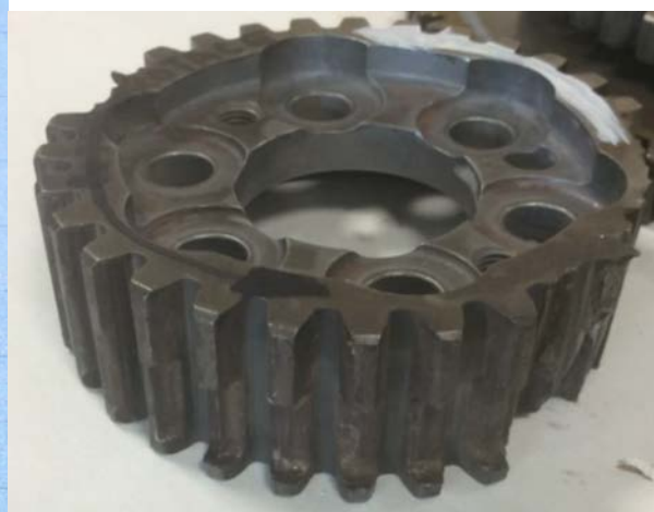
Obr. 3.5: Detail poškození lokality L12
