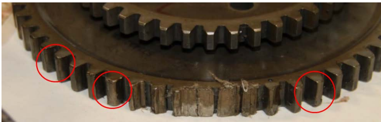
Obr. 6.1: Poškození čel zubů kola L2
