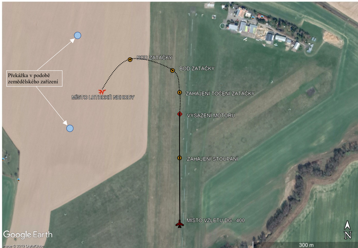
Obr. 9 - Trajektorie kritické fáze letu DG–400 po vzletu z RWY 36 LKSU
