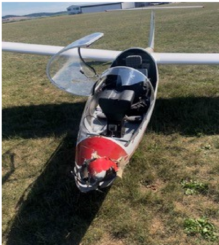
Obr. č. 2 – Poškozený kluzák po tvrdém přistání
