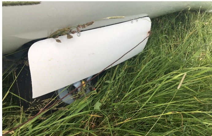
Obrázek č. 3 Zachycení drátu ohradníku o podvozek kluzáku
