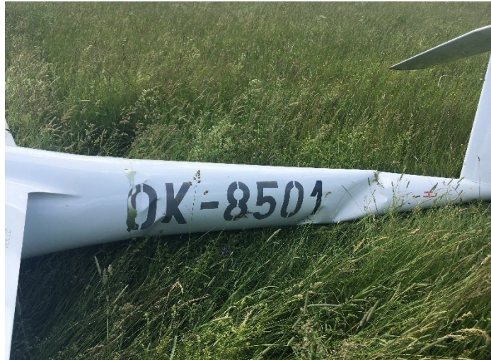
Obrázek č. 2 Deformace zadní části trupu – kornoutu
