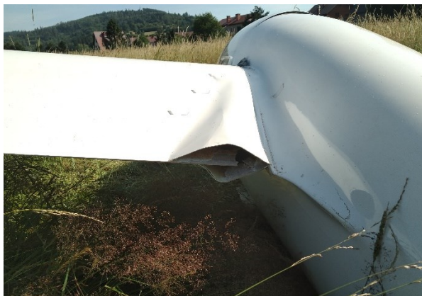
Obrázek č. 2 Poškozený potah levé poloviny křídla.
