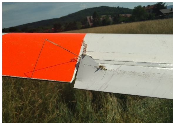
Obrázek č. 3 Poškození křídélka.
