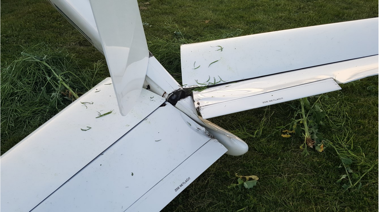
Obr. 5 - Detail poškození ocasních ploch a zadní odklopné části trupu
