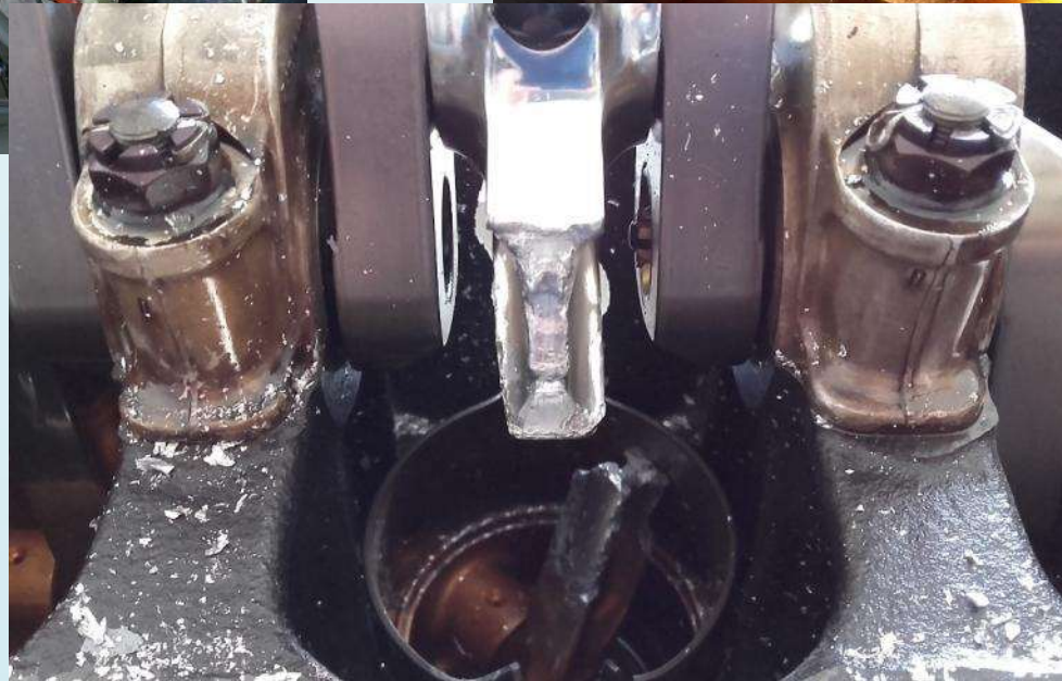
Prasklá ojnice válce č. 3.
