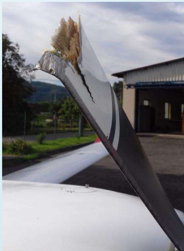
Poškození listu vrtule
