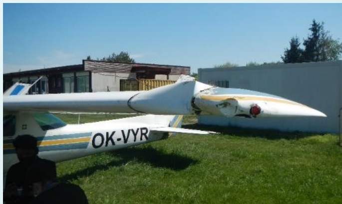
Poškozený konec levého křídla letoun F152
