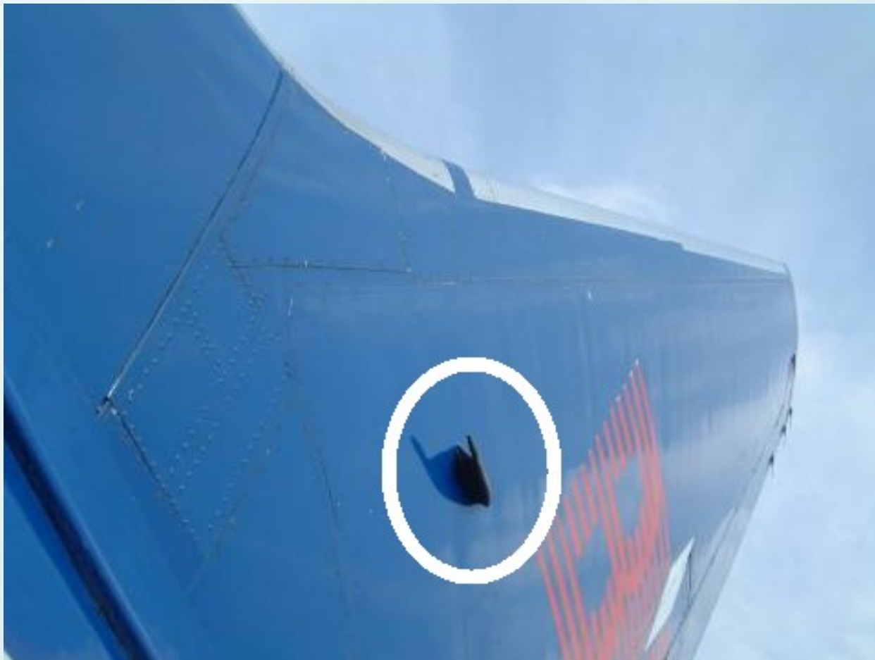
Umístění snímačů tlaku na kýlu letounu Boeing 737-800
