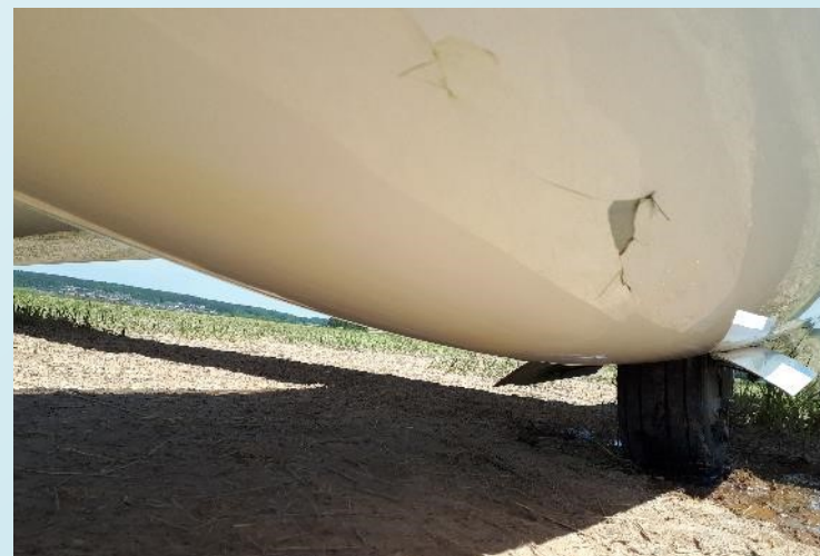
Spodní přední část trupu – poškození
