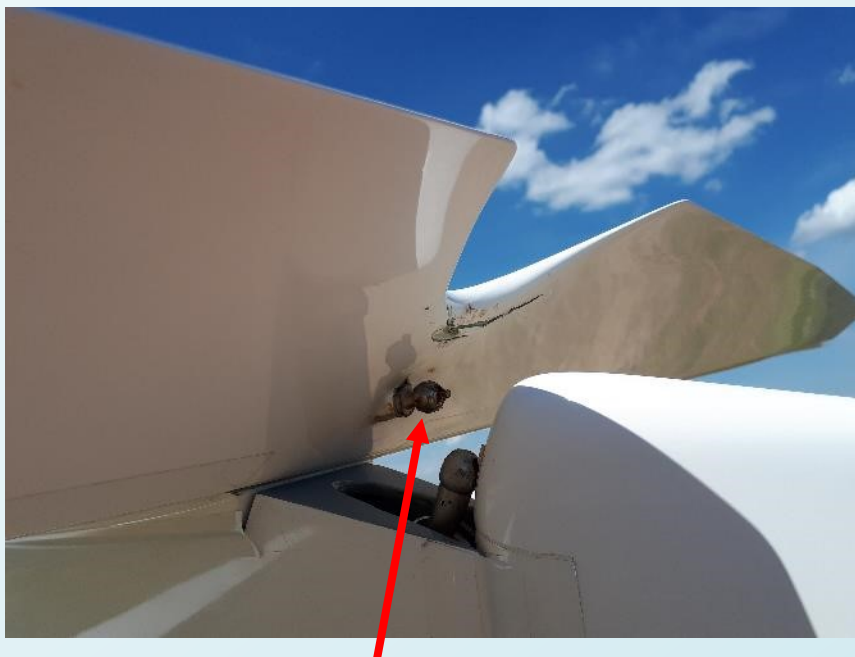
Nezapojené táhlo ovládání výškového kormidla
