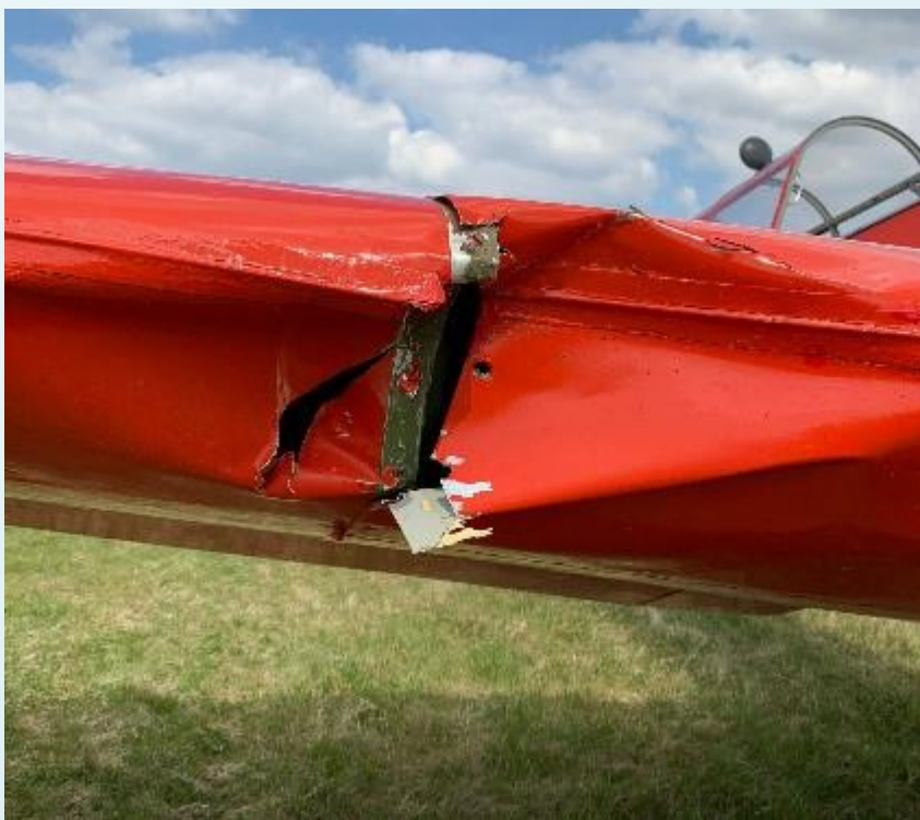
Poškozená pravá polovina křídla Z-226 MS
