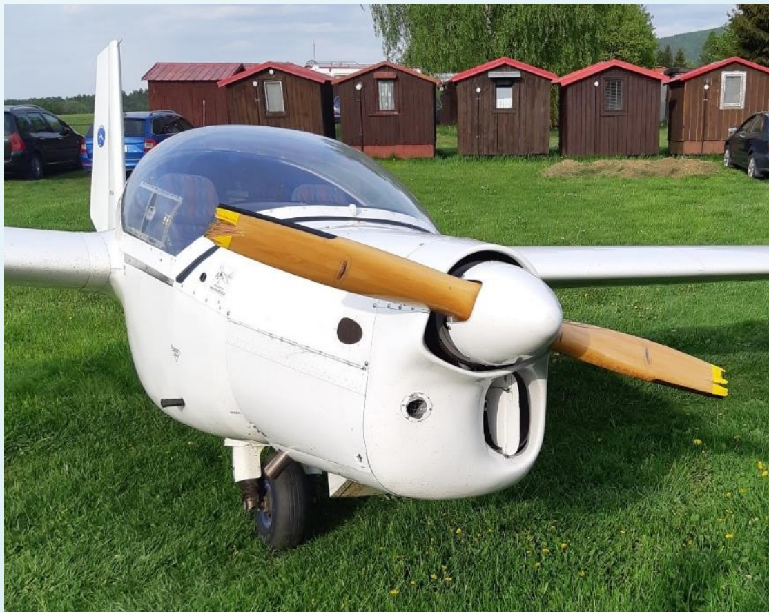
Poškození listů vrtule
