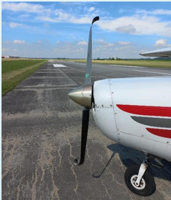
Poškození letounu Cessna 150
