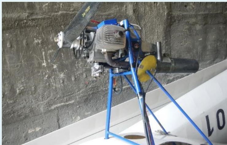
Dvouválcový dvoutaktní vzduchem chlazený motor určený výhradně pro modelářské použití
