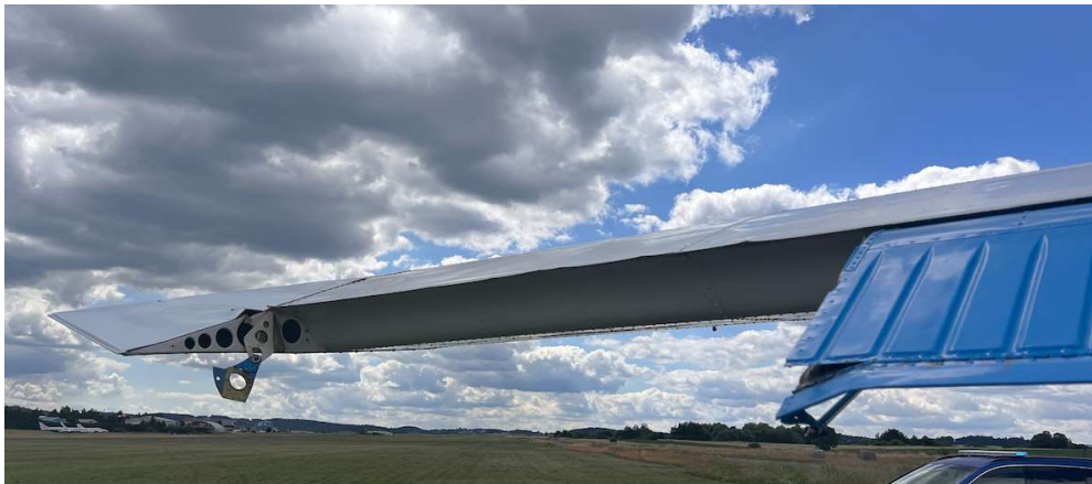
Obrázek 3 – Poškození levé poloviny křídla vytržením vnější poloviny křídélka.
