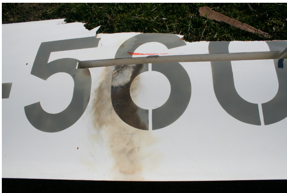
Obr. 4 Stopy elektrického výboje na spodní straně levé poloviny křídla
