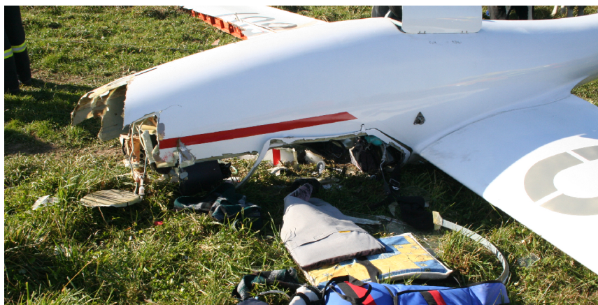
Obr. 3 Destrukce přídě a pilotní kabiny
