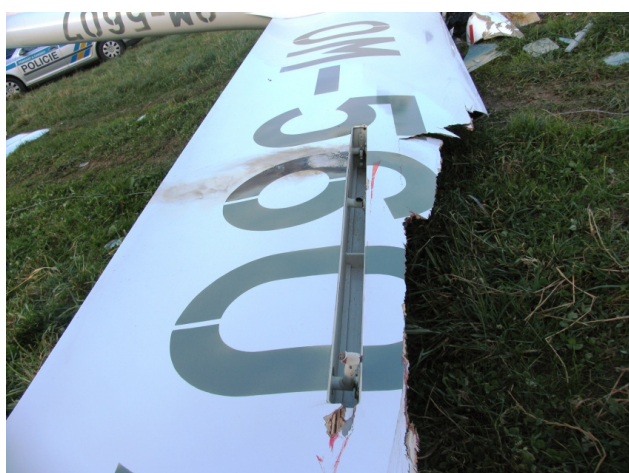
Šachta brzdící klapky a stopy po výboji
