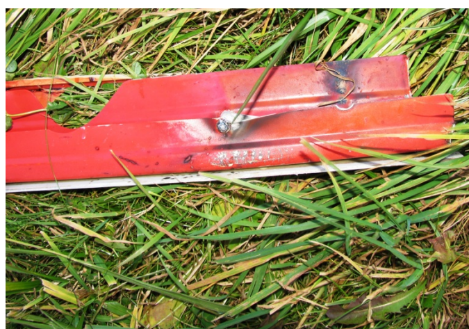
Oddělená brzdící klapka a stopy po výboji
