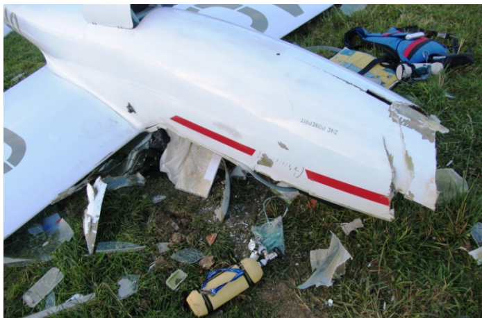
Destrukce přídě kluzáku
