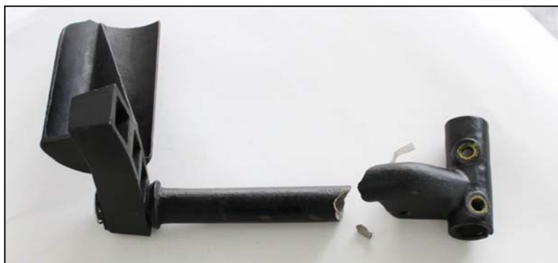
Obr. 4 Demontovaná rozlomená stojina levého pedálu
