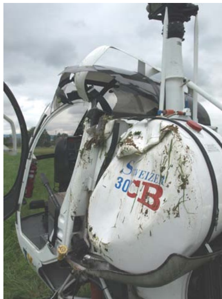
Obr. 2 Poškozený levý bok vrtulníku OK-XIS
