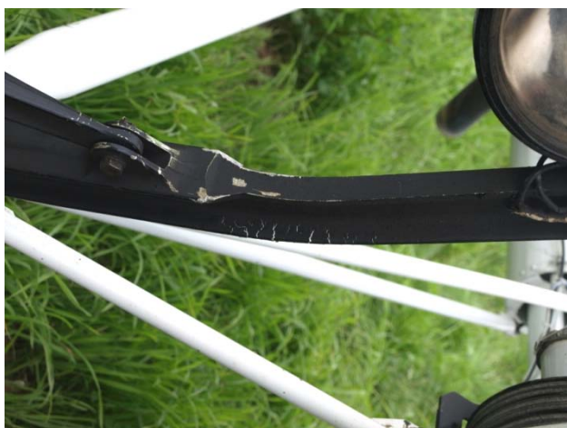
Poškození vzpěry ližin
