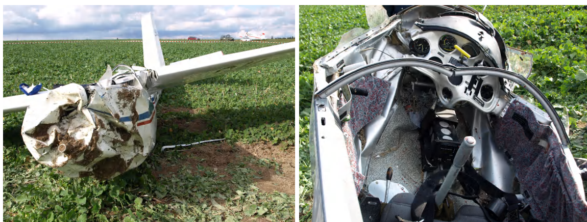
Obr. 3 Fotografie zobrazují deformaci předního pilotního prostoru kluzáku
