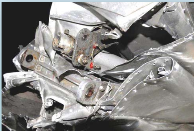
Pásnice nosníku levého křídla ke kontrole mechanických charakteristik materiálu podle Bulletinu.
