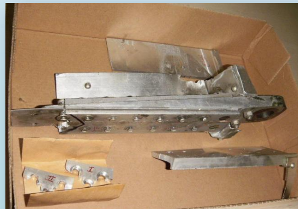
Pásnice nosníku levého křídla ke kontrole mechanických charakteristik materiálu podle Bulletinu.
