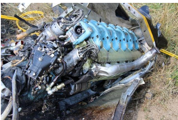
Pohled na zadní část motoru a deformaci příruby vrtule
