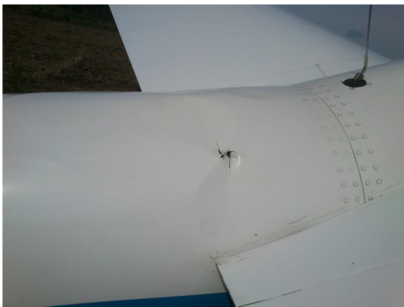
Obr. 1: Zborcení a protržení potahu trupu za centroplánem
