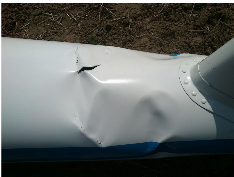
Obr. 2: Zborcení a protržení potahu trupu před kořenovou částí kýlu
