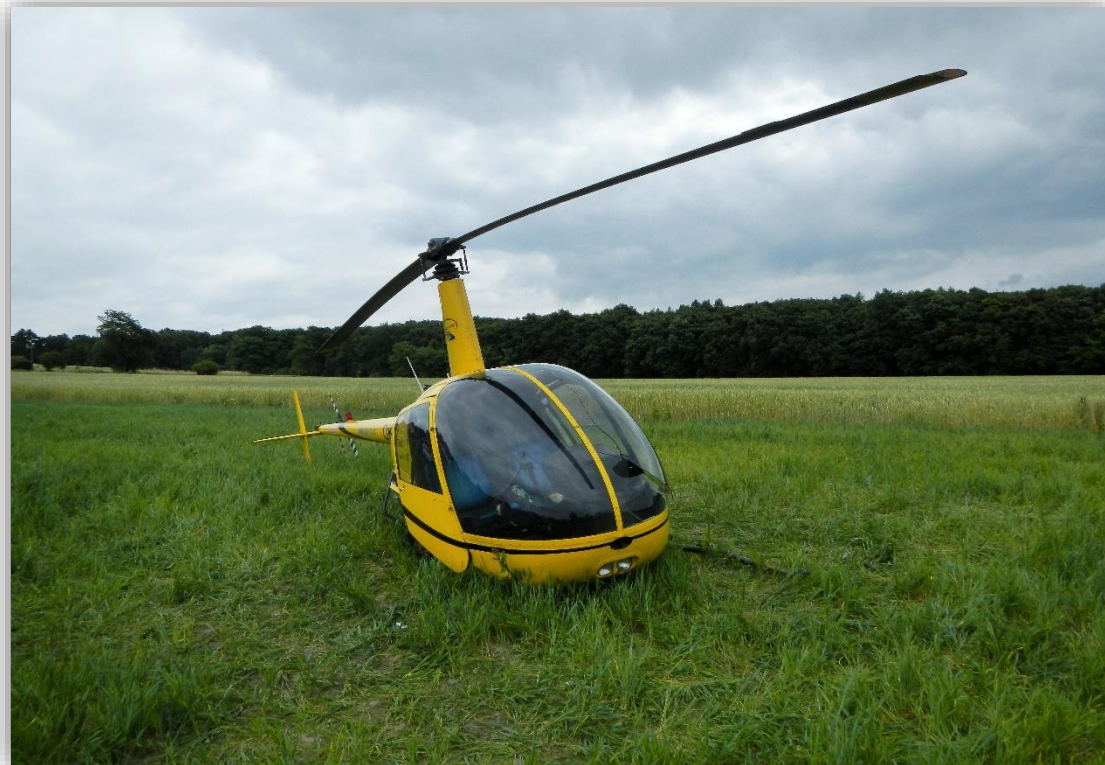
Obr. 1: Vrtulník R 22 po tvrdém přistání
