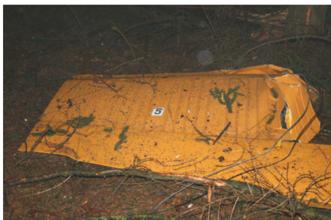
Vnější část (5) roztržené levé poloviny křídla a vnitřní část spojená s centroplánem.
