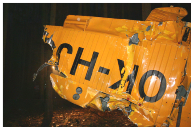
Vnější část (5) roztržené levé poloviny křídla a vnitřní část spojená s centroplánem.
