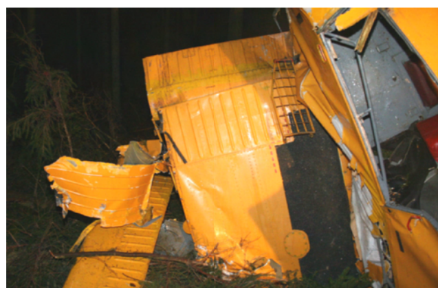
Vnější část (5) roztržené levé poloviny křídla a vnitřní část spojená s centroplánem.
