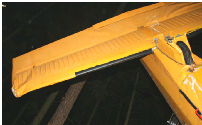
Vodorovná ocasní plocha a místo odtržení kýlu.
