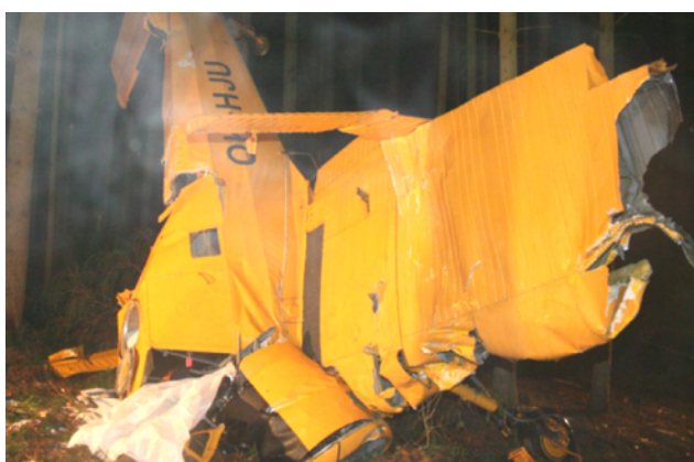
Vnější část (5) roztržené levé poloviny křídla a vnitřní část spojená s centroplánem.
