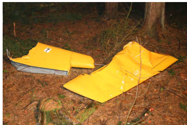
Odtržený kýl (7) a směrové kormidlo.
