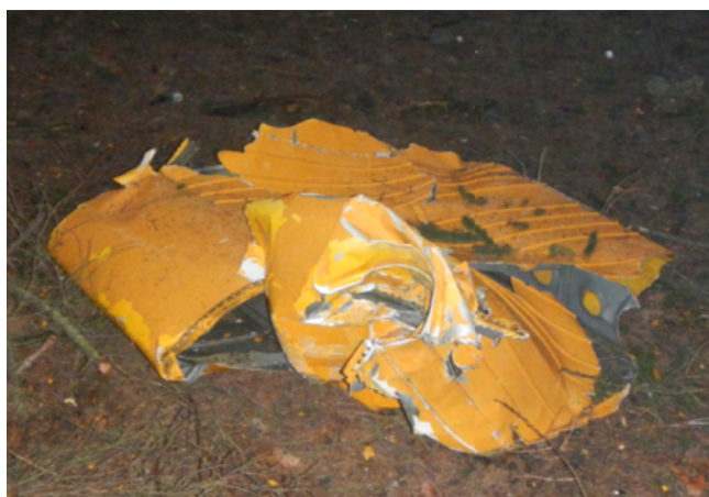
Vnitřní část a vnější část (4) roztržené pravé poloviny křídla.
