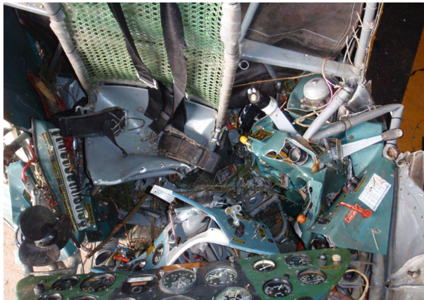
Obr. 7 Pohled na deformaci pilotní kabiny (stav po vyjmutí radiostanice).
