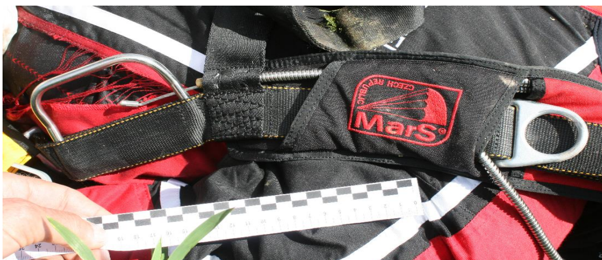
Obr. 4: Uvolňovač záložního padáku a kovový kroužek
