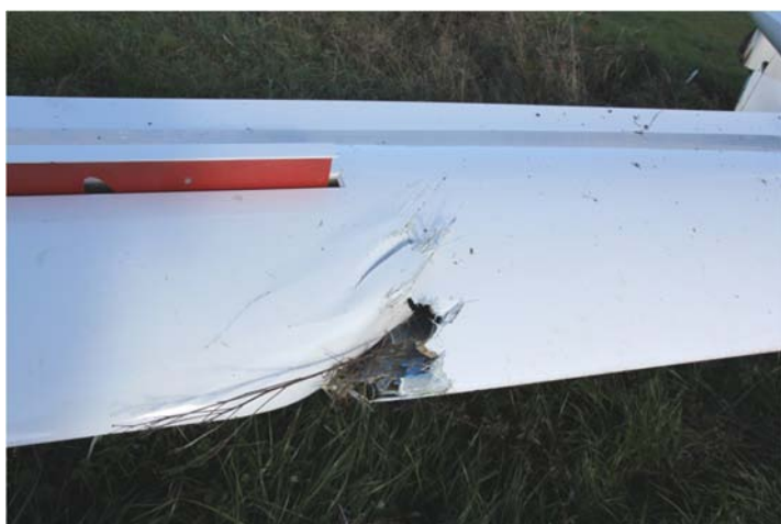
Poškození pravé vnitřní části křídla
