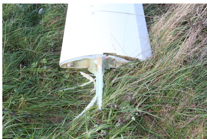
Destrukce kořene levé vnější části křídla a odlomená levá vnější část
