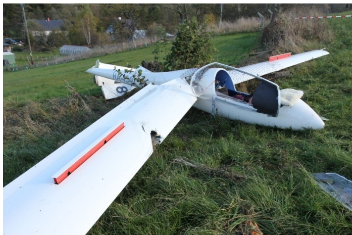
Poškození krytu kabiny a křídla
