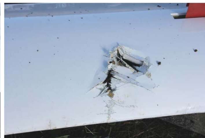
Poškození levé vnitřní části křídla
