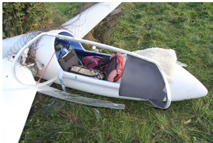
Poškození krytu kabiny a křídla
