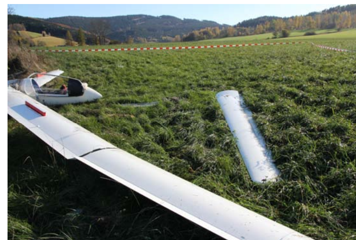
Destrukce kořene levé vnější části křídla a odlomená levá vnější část
