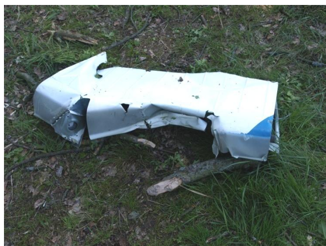
Levá křídélko utržené z levé poloviny křídla
