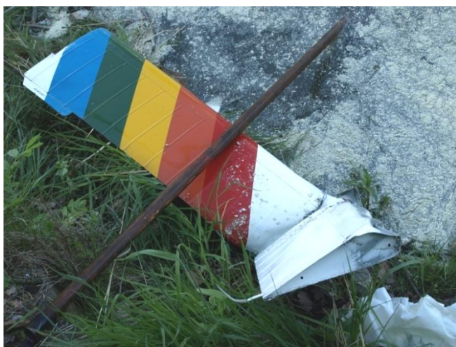
Pravé vnější křídélko utržené z pravé poloviny křídla
