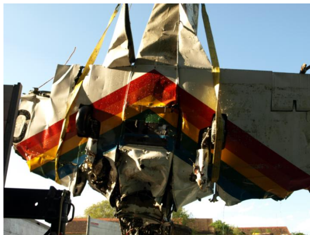
Stav spodní části trupu, zasunutý podvozek
