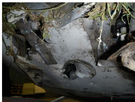
Pohled na poškozenou spodní část trupu
