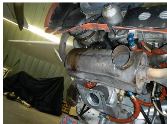
Detail poškození soustavy sání vzduchu
