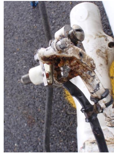
Rozlomená oka zlomovací vzpěry a vzpěra pravé nohy hlavního podvozku
