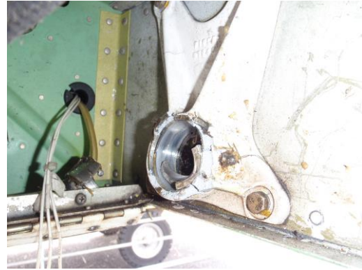
Stav předního a zadního kování čepů pravé nohy hlavního podvozku
