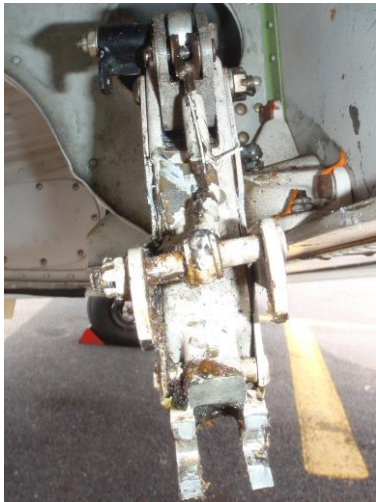
Rozlomená oka zlomovací vzpěry a vzpěra pravé nohy hlavního podvozku
