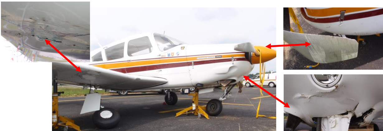
Poškození potahu křídla krytu motoru a vrtule
