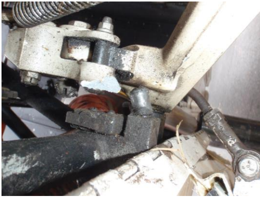
Rozlomený hák zámku vysunuté polohy a ohnutý čep zámku
