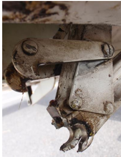
Rozlomená oka zlomovací vzpěry a vzpěra pravé nohy hlavního podvozku
