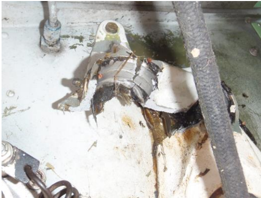
Stav předního a zadního kování čepů pravé nohy hlavního podvozku
