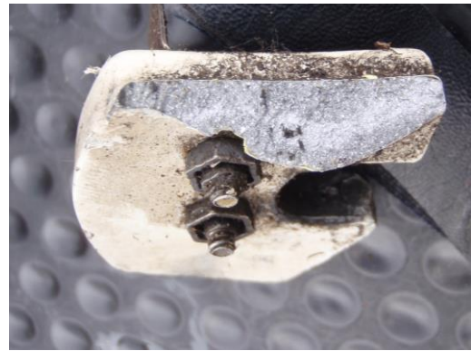
Rozlomený hák zámku vysunuté polohy a ohnutý čep zámku
