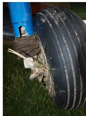
Poškozený disk levého kola hlavního podvozku
