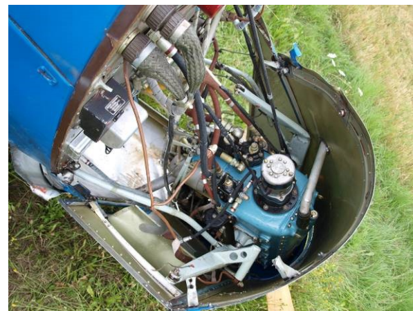
Vytržení a deformace motorového lože
