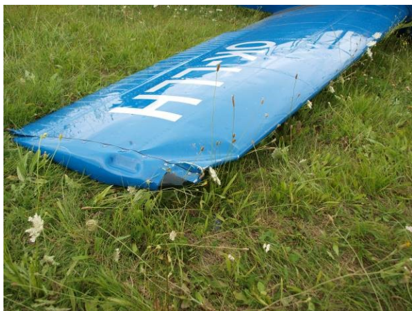
Poškození okraje pravé poloviny křídla
