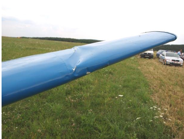
Poškození levé poloviny křídla
