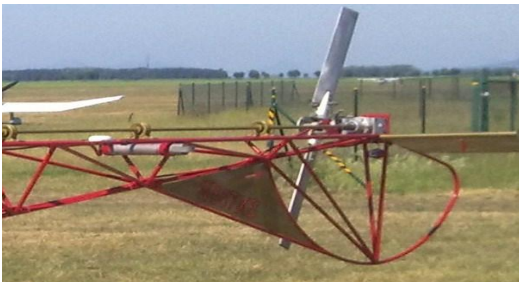
Obr. č. 6: Umístění balastního závaží při obsazení dvěma osobami
