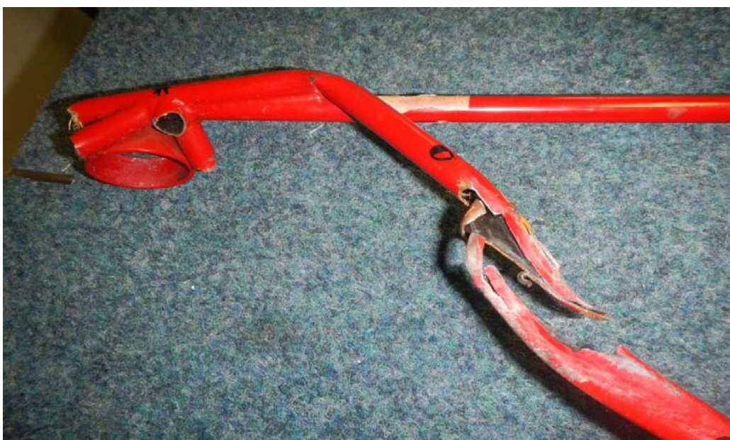
Obr. č. 8: Úchyt balastního závaží na pravé straně ocasního nosníku
