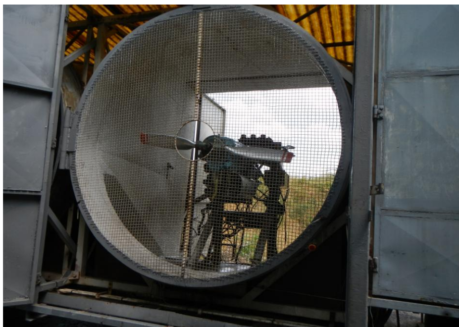
Motor nainstalovaný na motorové zkušebně
