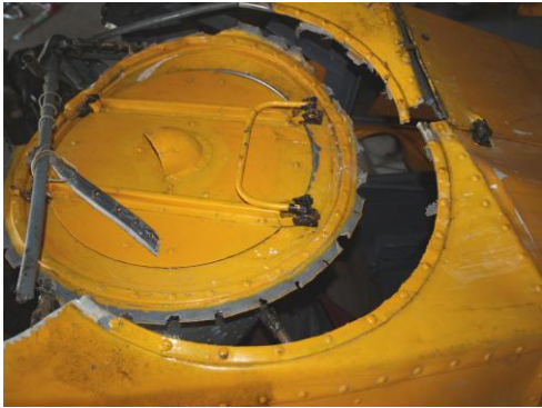
Stav víka nádrže na chemikálie
