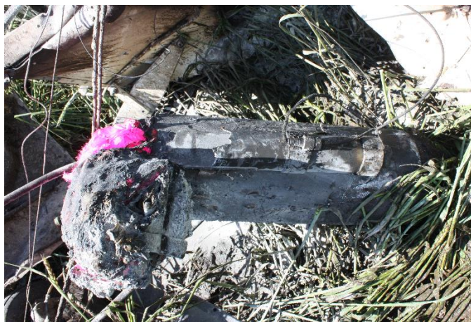
Záchranný systém poškozený vysokou teplotou
