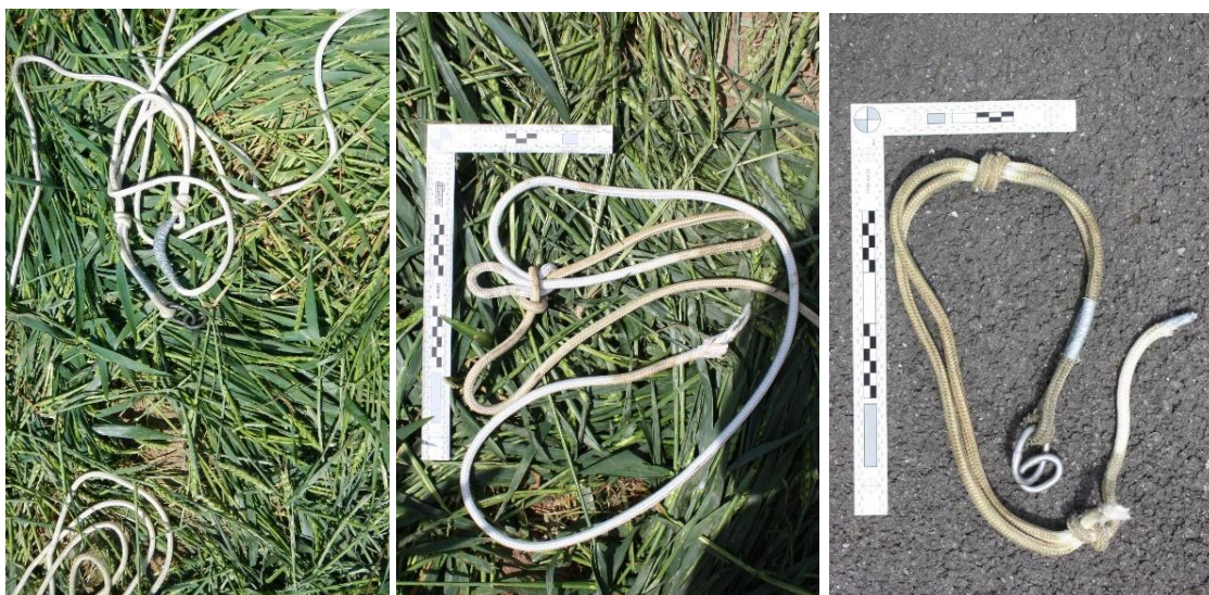
Obr. 4 Fotografie obou kusů přetrženého vlečného lana.
