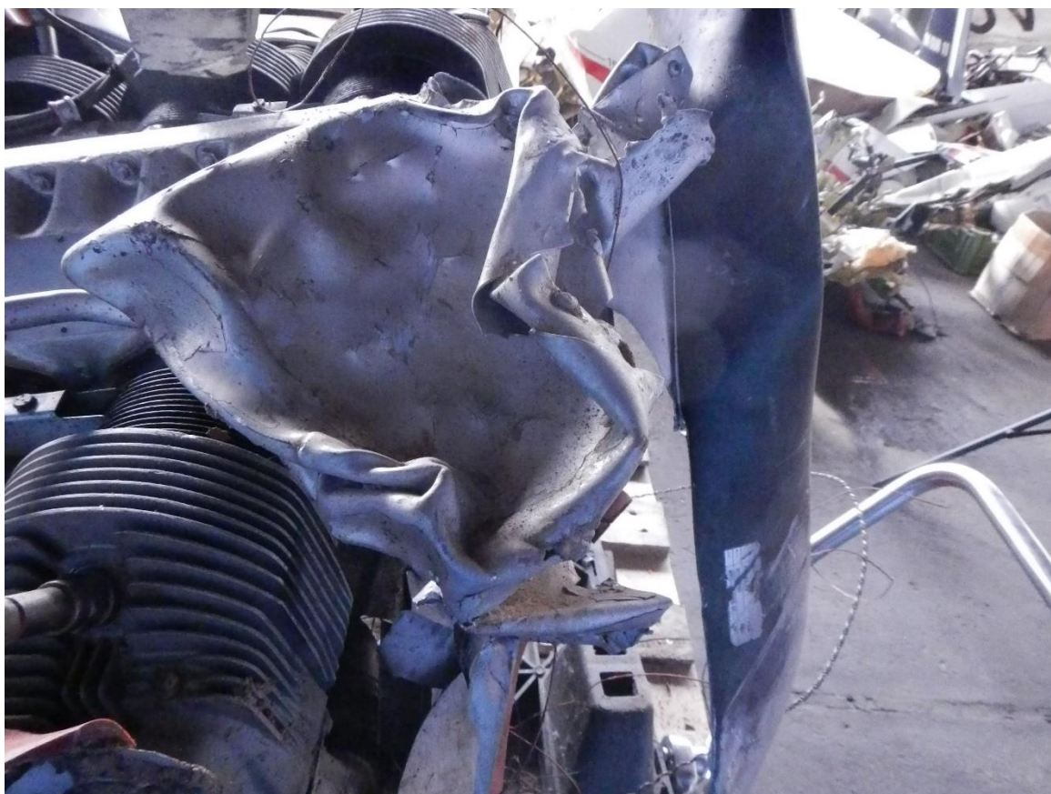
Obr. 15: Poškození vrtulového kužele
