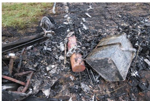
Ohořelá hlavní a spádová palivová nádrž
