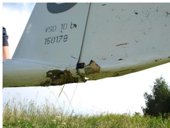
Poškození spodní části trupu a směrového kormidla
