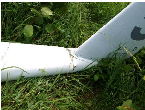
Poškození zadní části trupu před kýlem
