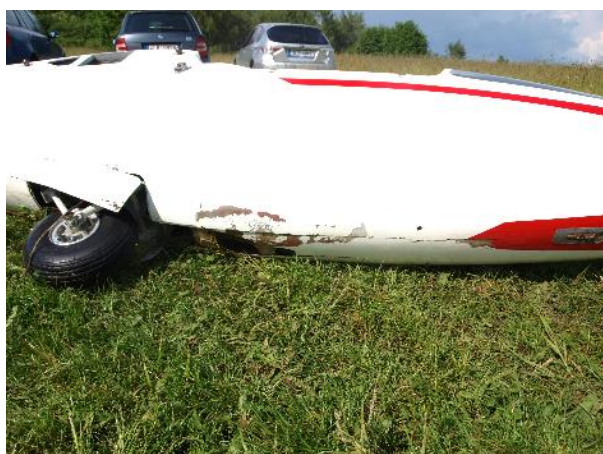
Poškození spodní části trupu a směrového kormidla
