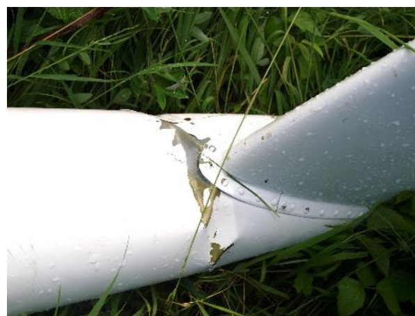
Poškození zadní části trupu před kýlem
