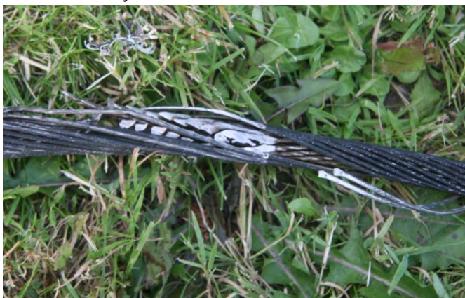
Poškozený vodič vedení 22 kV
