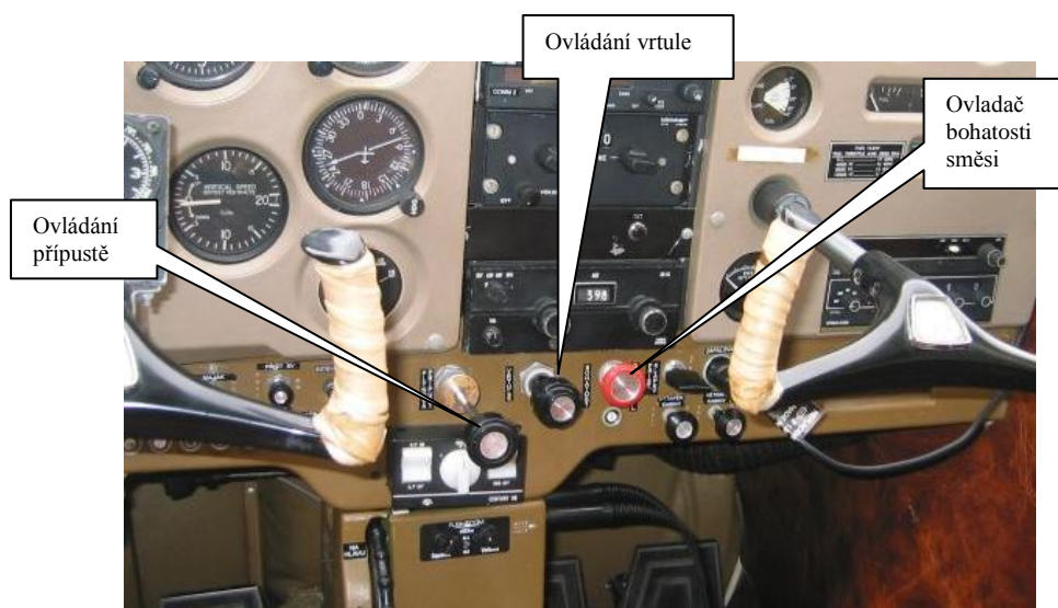
Uspořádání ovládání motoru letounu Cessna FR 172H, OK-JAS, (identické s letounem Cessna FR 172H, OK-AKM)
