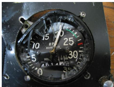
Údaj na otáčkoměru po nehodě
