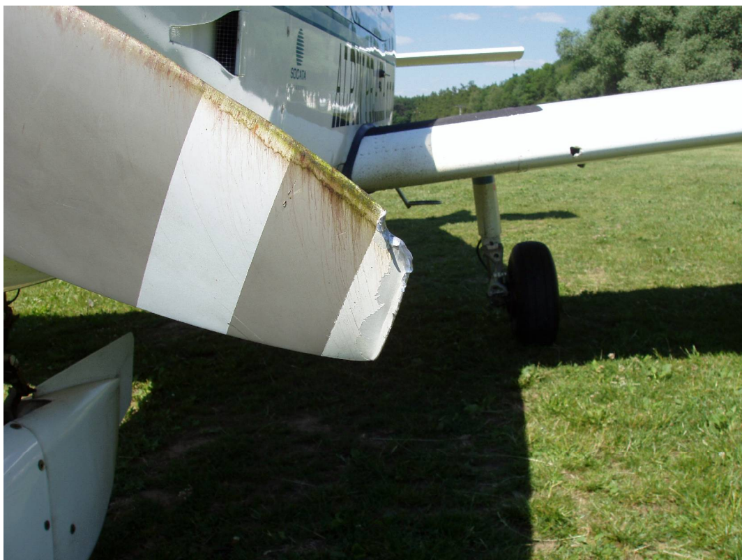
Poškození vrtule a náběžné hrany křídla.
