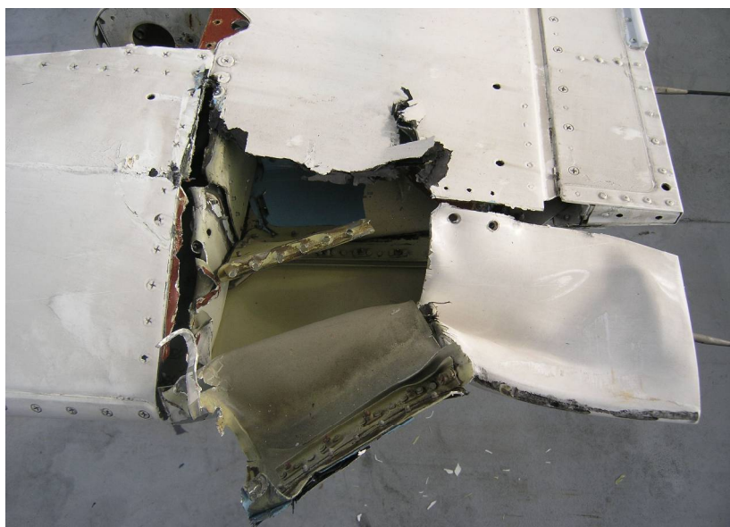
Poškození pravého křídélka a rohového odlehčení pravého křídélka
