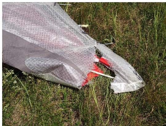
Poškození potahu na pravé polovině a levého okraje křídla kluzáku.
