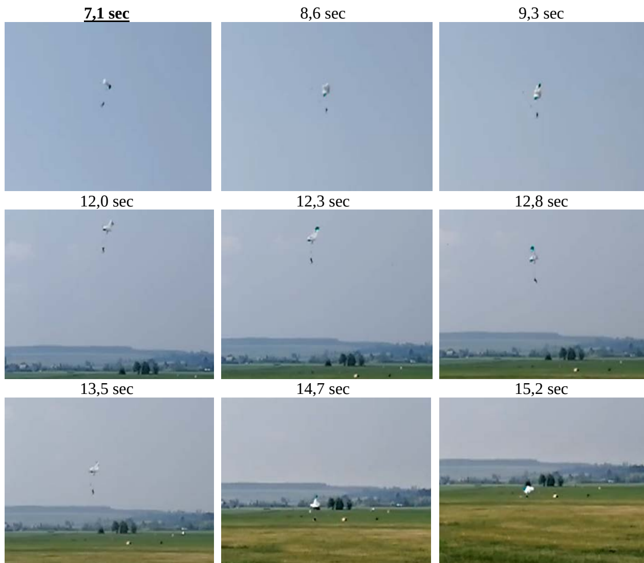
Obr. č. 7: Pád na částečně zkolabovaném vrchlíku hlavního padáku po ruční aktivaci záložního padáku
