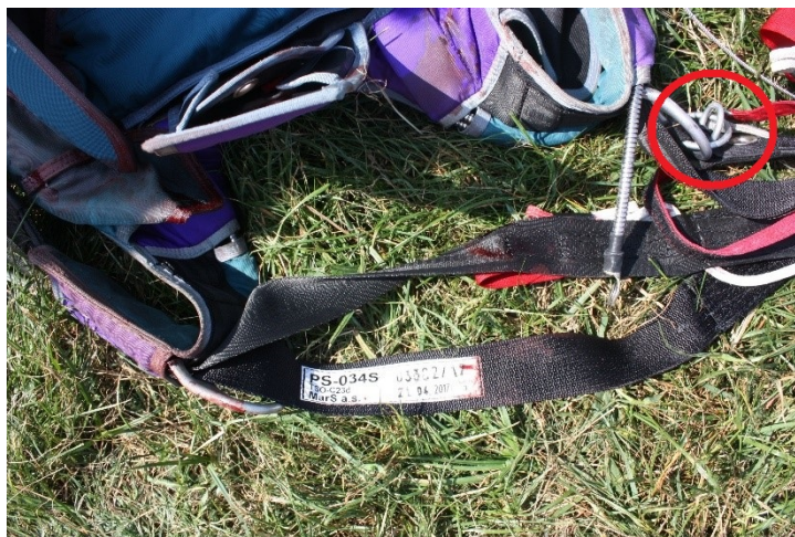
Obr. č. 2: Stav tříkroužkového systému na levé straně postroje
