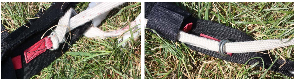
Obr. č. 3: Stav levé (zabrzděné) a pravé (odbrzděné) řídicí šňůry po dopadu na zem
