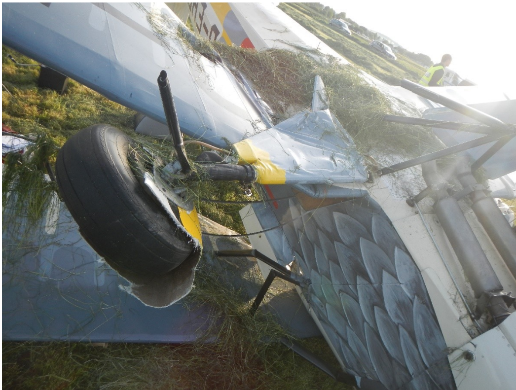
Obr. 12 – Poškození podvozku, zlomená levá podvozková noha s poškozeným aerodynamickým krytem kola. Ve středu snímku jsou vidět zlomené vzpěry upevnění horního křídla.
