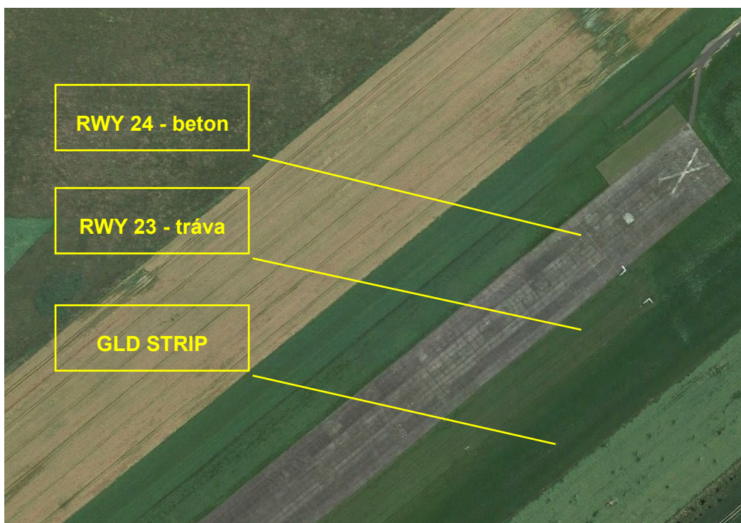
Obr. 15 – Vizuální označení RWY 24 a GLD STRIPU, které neodpovídalo požadavkům předpisu L 14 Letiště a RWY 23.
