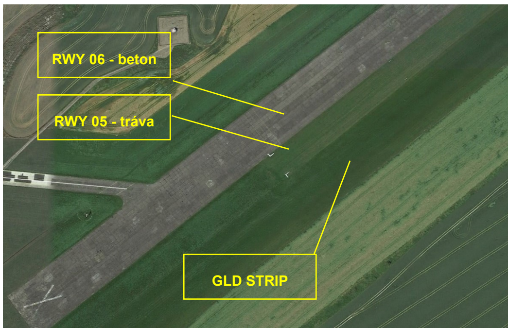
Obr. 16 – Vizuální označení RWY 06, RWY 05 a chybějící označení GLD STRIPU.
