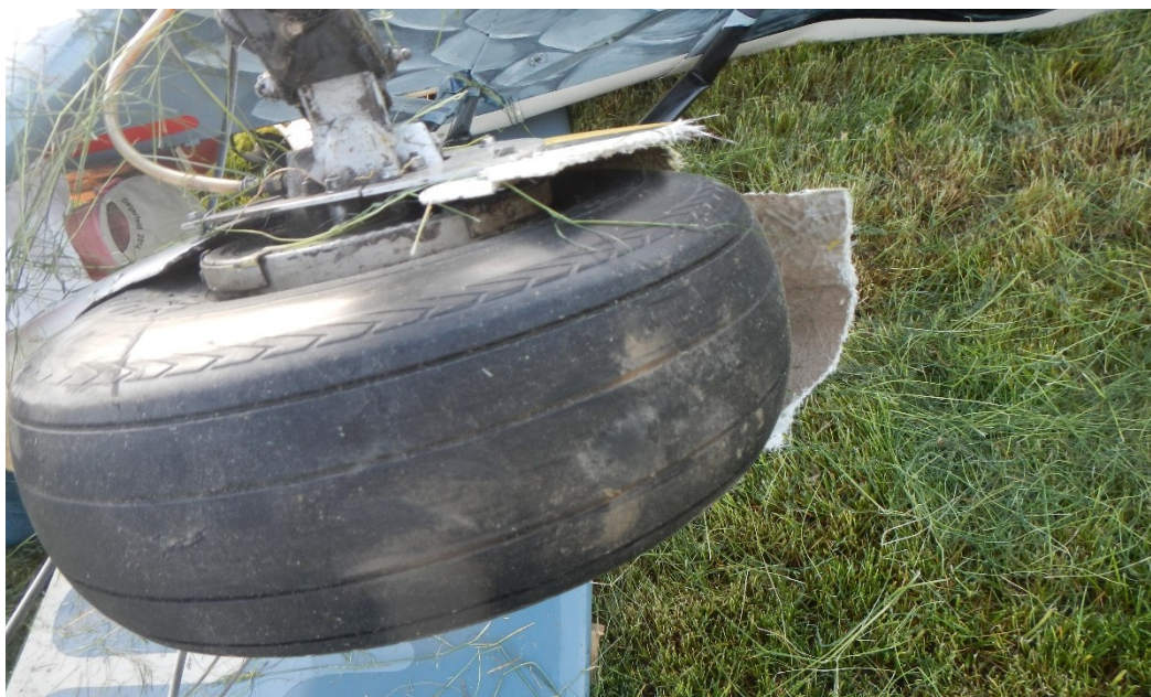
Obr. 4 – Stopy zeminy na levém podvozkovém kole a rozbitý aerodynamický kryt kola po vjetí do prohlubně na plachtařské pásu.
